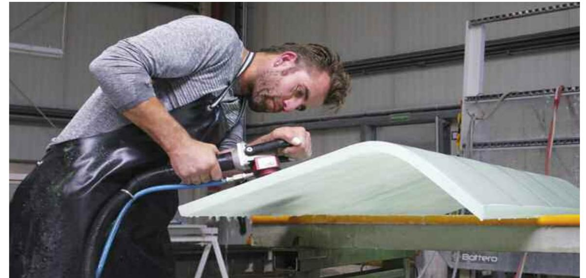
Bei Glaskeramik handelt es sich um ein Material, welches zu 100 % aus Recyclingglas besteht. Durch die während dem Sinterungsprozess entstandene Kristallbildung verändert sich das reine Glasmaterial zu unserer einzigartigen Glaskeramik. Dadurch ist eine weitere Bearbeitung mit ähnlichen Maschinenwerkzeugen wie bei der Verarbeitung von Natursteinen und vor allem Großkeramiken möglich.
